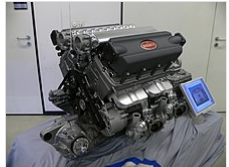
Motor de gasolina W16 de Bugatti Veyron
