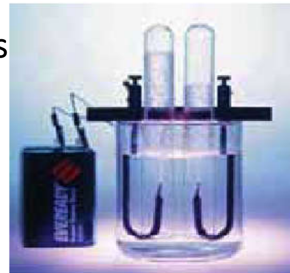
▲ Figura 1.7 El agua se descompone en sus elementos constituyentes, hidrógeno y oxígeno, cuando se hace pasar una corriente eléctrica directa a través suyo. El volumen de hidrógeno (derecha) es el doble que el volumen de oxígeno (izquierda).
